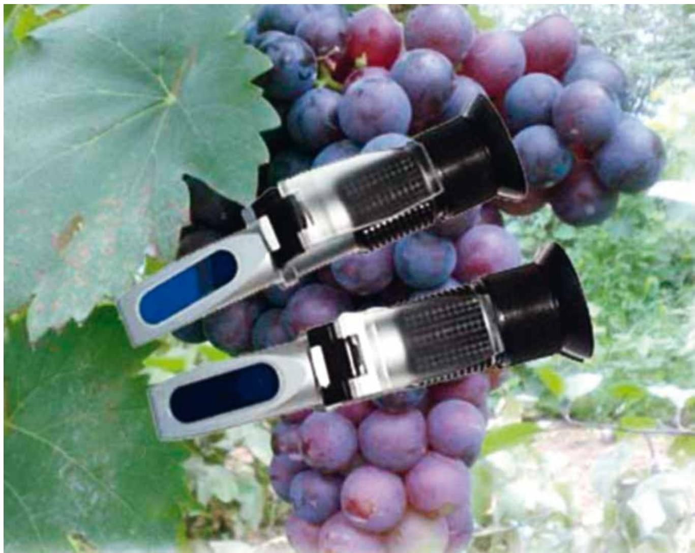
**HB 18ATC:** Rifrattometro ottico scala 0-20% brix.
