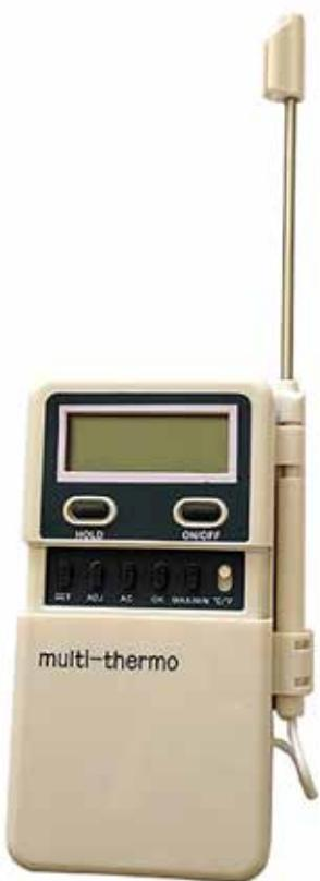
Termometro elettronico con sonda e cavetto
